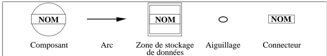
Figure I.8 : Les différents objets composant un diagramme PROTO.
